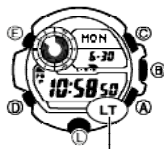
Automaattisen valokytkimen ilmaisin
